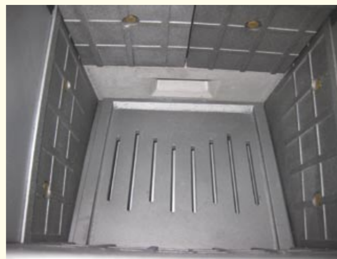
• Velký příkladací prostor umožňuje vkládat špalky až 33 cm dlouhé. Dole pod dvířky je vidět spínač, který aktivuje v případě otevření odtažový ventilátor tak, aby nedošlo k zakouření obslužného prostoru. Spaliny a kouř je nasáván do kanálu, který je vidět nad příkladací komorou. Vnitřní část příkladací komory je vystlána nerezovými plechy, které lze v případě poškození jednoduše demontovat a vyměnit. Směr otevírání příkladacích dvířek je možno zaměnit. • Pohled do spodní části příkladací komory. Celý prostor, ve kterém je vytvářen dřevoplyn z dřevěného uhlí vzniklého z kusového dřeva, je vyložen litinovými pláty, u kterých nehrozí rozbití a rozdrolení, jako se děje u kotlů, které v tomto prostoru mají šamot nebo keramiku.
