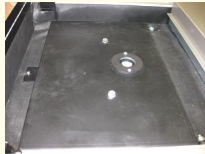
• Pohled na zavřený výměník a vyhořivací komoru s průhledítkem.
