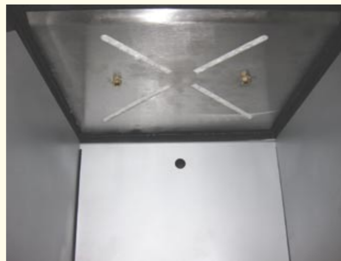
• Pohled do horní části příkladací komory, která je celá vyložena nerezovými plechy.
