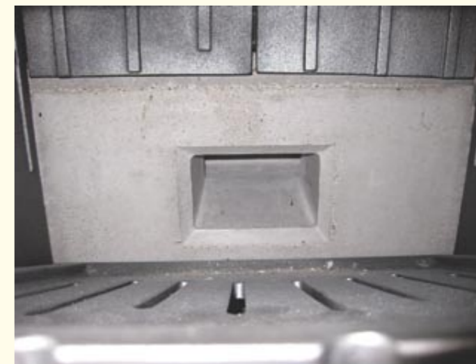
• Detailní pohled do popelníkového prostoru a na trysku.
