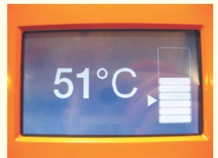
• Poslední obrazovka slouží jako spořič a zobrazuje velkým číslem a grafickou stupnicí stav nabití AKU nádrže.
