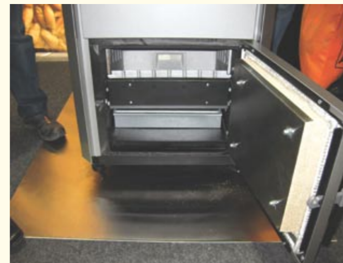
• Za popelníkovými dvířky se nachází popelníkový prostor s plechovým vyjímatelným popelníkem, litinový rošt a vzadu je vidět tryska, která se nachází v žárobetonu.
