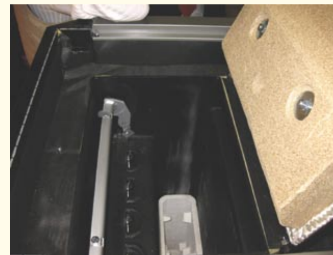
• Pohled na výměník a vyhořívací komoru z boku. Vpravo jsou otevírací dvířka s průhledítkem, kterým je možno pozorovat vyhořívání dřevoplynu.
